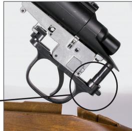
Setzen Sie den Upper Body mit Lauf in den unteren Teil mit Schaft ein. Achten Sie dabei darauf, den Winkel einzuhalten und den durch den Kreis gekennzeichneten Teil in die entsprechende Aussparung im Schaft einzusetzen.
