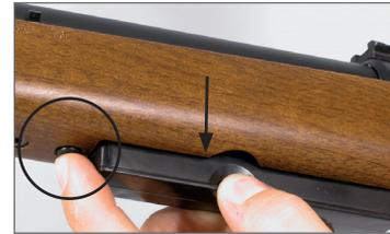
Drücken Sie die Magazin-Entriegelung, um das Magazin zu entnehmen und ziehen Sie es aus der Waffe.
